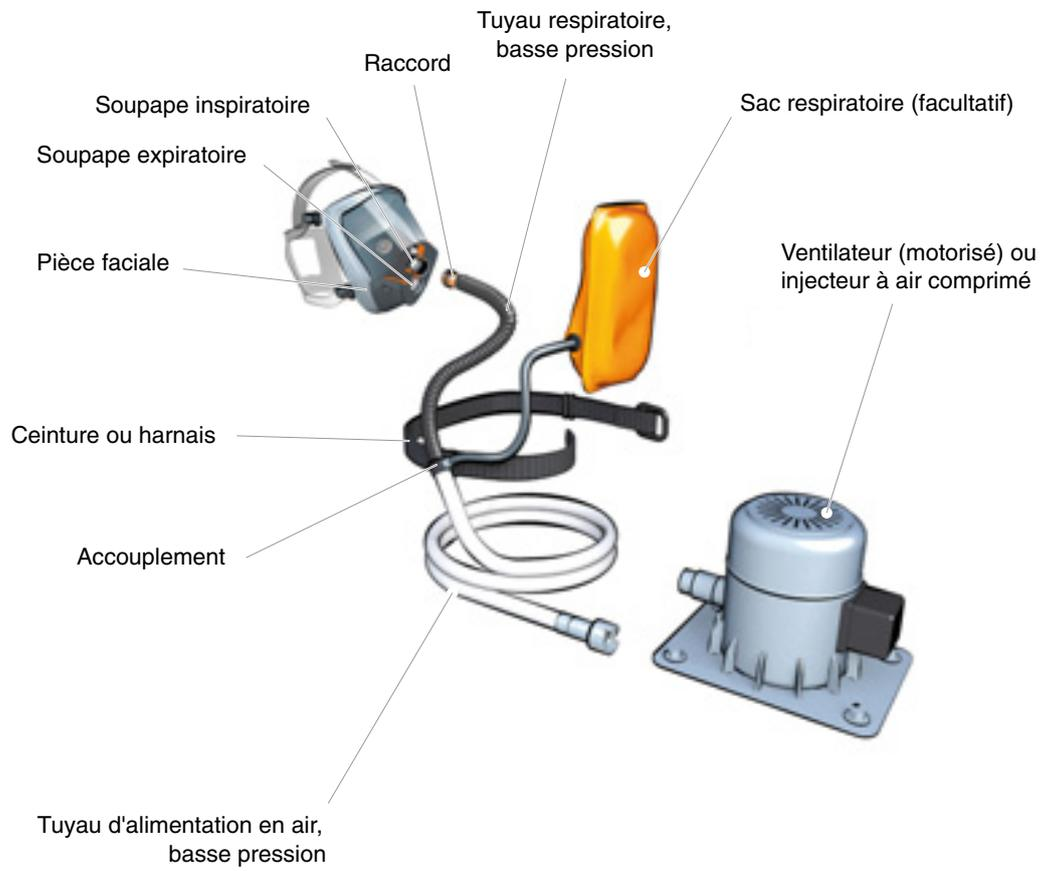
Appareil isolant à adduction d'air comprimé, type à débit continu
